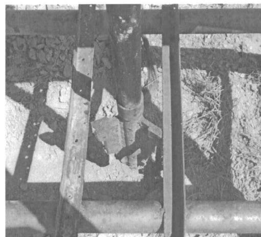
PERFORACIÓN CON EQUIPO DE ROTACIÓN MECÁNICA Y BROCA DE 12"
